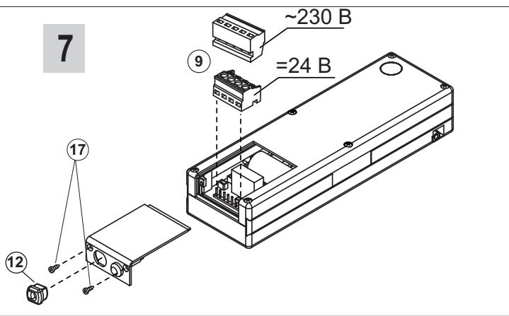
Электрическое подключение привода VARIA 230V
